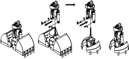
Schalen mit Schalenträger durch 3-Punkt-Stecksystem innerhalb der gesamten Baureihe austauschbar
