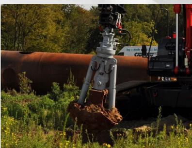
Spezieller Greifer für den Hydraulikbaggerbetrieb, wie
