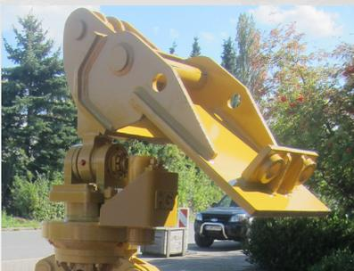
Die Drehwerke DWP-10 wurde für den Einsatz an hydraulischen Anbauwerkzeugen für Hydraulikbagger, sowie für mobile und stationäre Umschlagmaschinen konzipiert. Es werden mit dem DWP-10 drei Funktionen für den Betrieb des Anbauwerkzeugs übernommen:
