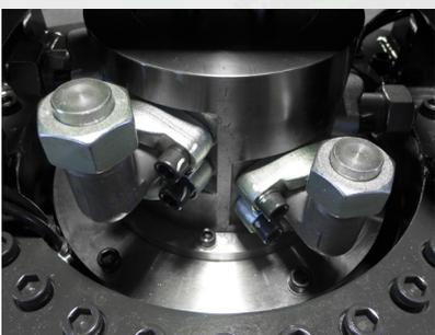
Die Drehwerke DWP-40-2 wurde für den Einsatz an hydraulischen Anbauwerkzeugen für Hydraulikbagger, sowie für mobile und stationäre Umschlagmaschinen konzipiert. Es werden mit dem DWP-40-2 drei Funktionen für den Betrieb des Anbauwerkzeuges übernommen:
