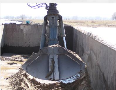
Optimierter Greifer für den Schüttgutumschlag, wie z.B.: Kies, Sand, Schotter, Getreide, Futtermittel, Dünger, Erze, Kohle usw.
