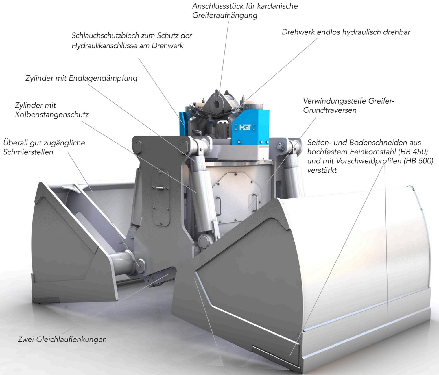
Schalen- und Gleichlauflagerung abgedichtet
