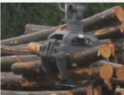
Umschlaggreifer für Stamm- und Rundholz. Aufgrund der Zangenform können die TG2-Holzgreifer einzelne sowie mehrere Stämme unterschiedlichster Durchmesser vom Boden, Stapel oder LKW mühelos aufnehmen und sicher halten und handhaben.
