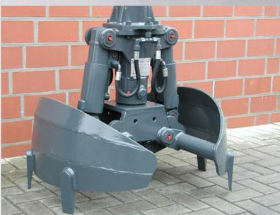
Grappin spécial pour l'exploitation sur excavateurs hydrauliques, telle que le creusement de puits de mine profonds et l'utilisation dans la construction de fondations.
