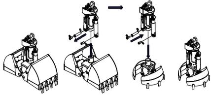
Coquilles avec porte-coquille interchangeables par système enfichable à 3 points au sein de l'ensemble de la série
