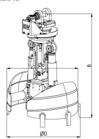
Pression de service (bar) : 350 préhension/140 rotation Densité apparente jusqu'à (t/m³) : 2
