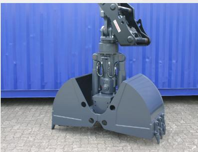
Benne preneuse universelle pour le fonctionnement typique sur excavateur hydraulique, tel que les travaux au puits et le curage de sols développés, le creusement de tranchées et de puits de câbles, le chargement de terre, de gravier et de sable.
