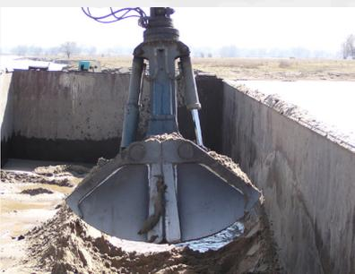
Benne preneuse optimisée pour le transfert du vrac tel que le gravier, le sable, les gravats, les céréales, les aliments, les engrais, les minerais, le charbon, etc.
