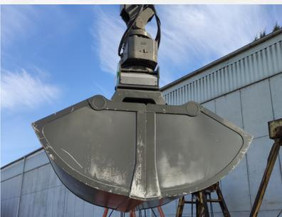
Benne preneuse optimisée pour les biens légers fluides tels que les granulés légers, les céréales, les aliments, les engrais.
